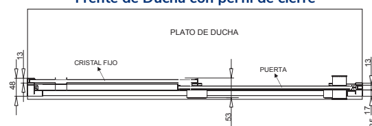
Dibujo técnico VO102 Frente de Ducha con perfil de cierre
