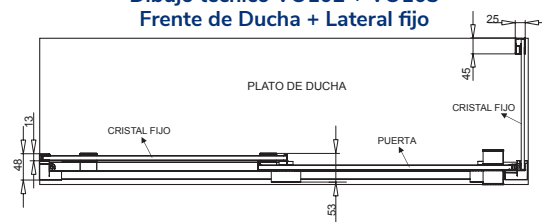
Dibujo técnico VO102 Frente de Ducha con perfil de cierre
