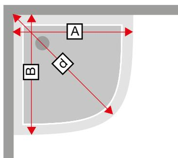
Medir los dos laterales (**A** y **B**) más la diagonal (**d**) y nos facilitan un dibujo como este, (indicando las medidas).
