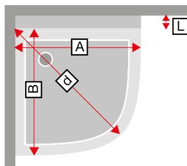
Medir los laterales (**A**, **B** y **L**) más la diagonal (**d**), y nos facilitan un dibujo como este, (indicando cada una de las medidas).
