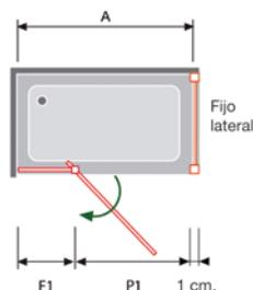
**Importante:** Cuando realice el pedido del fijo a medida, indicar si este va a la derecha o a la izquierda. También nos debe indicar si el anclaje del fijo va posicionado en el lado de la puerta abatible (como se muestra en la foto), o en el lado del fijo frontal.
